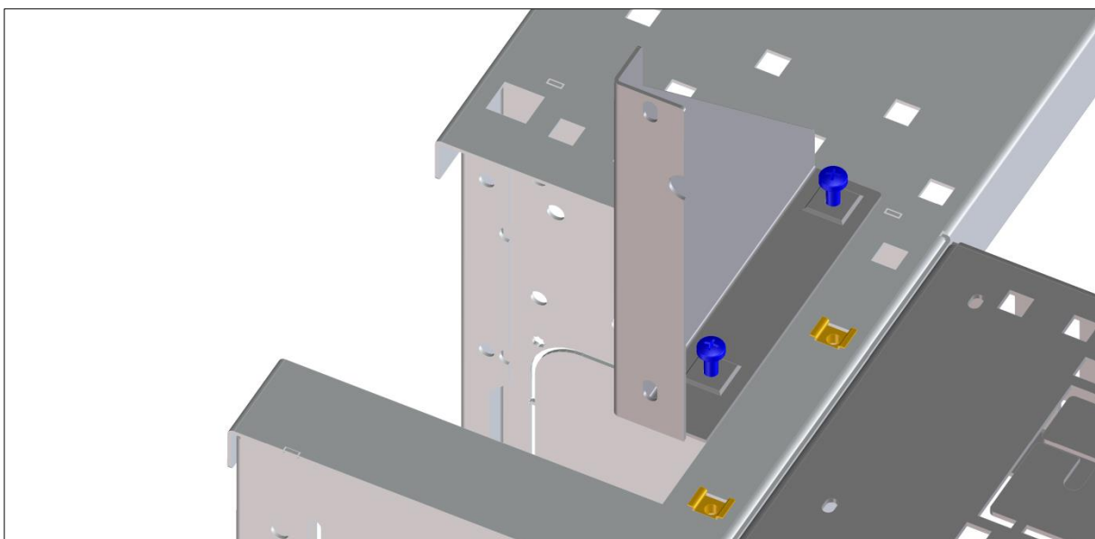
Abbildung 60: Detail - Montage der Dreiecksbleche
