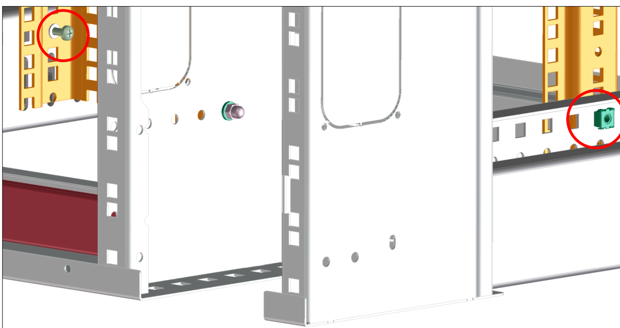
Abbildung 10: Befestigung der Rasterholme über Linsenschrauben
